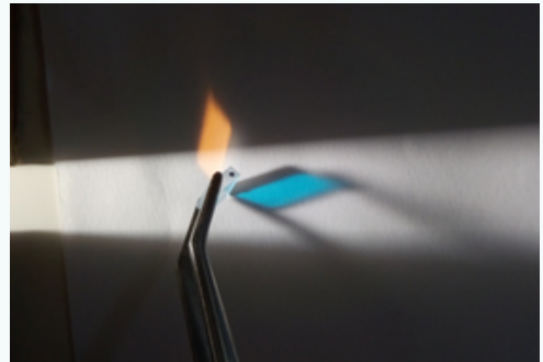
Figura 1: Vetro con rivestimento, usato come specchio in un lettore CD, investito da luce bianca (la sua frequenza operativa è nell'infrarosso, ma si vedono delle ripercussioni nel visibile)
